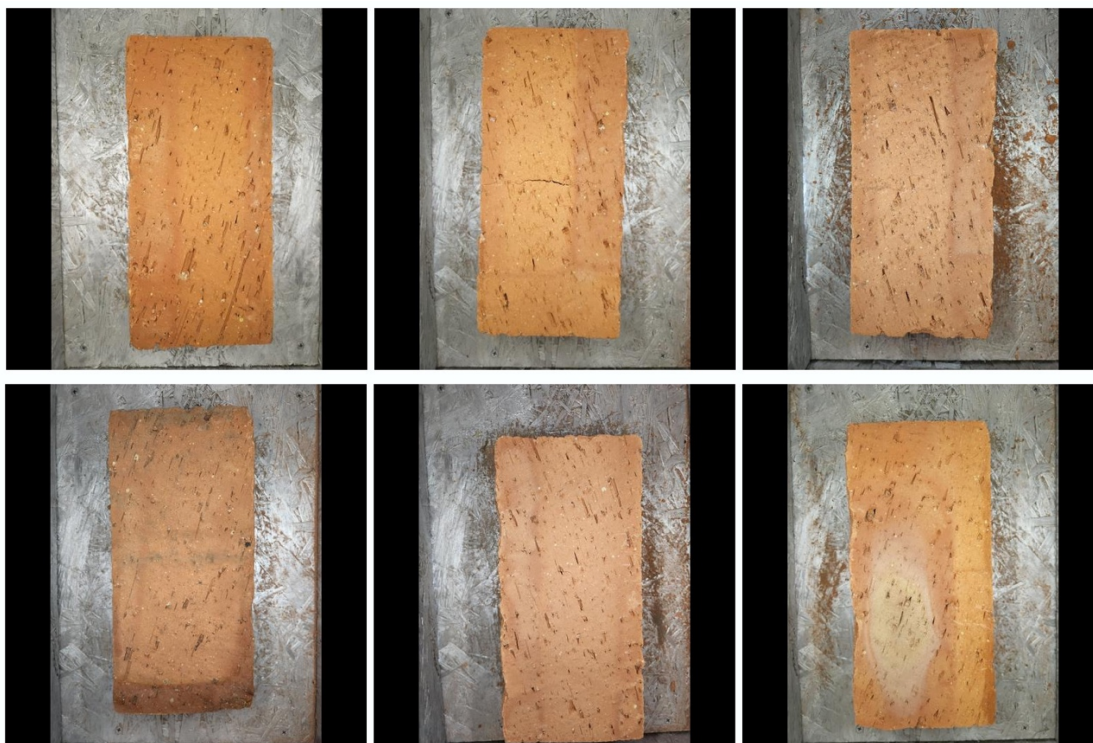
Рисунок 3. Дефекты кирпича: а) образец без дефектов, б) трещина, в) сколы, г) геометрические отклонения д) неровность кромки е) недожог
