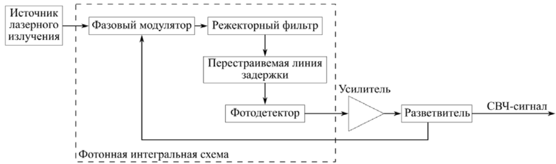
Рисунок 1. Структурная схема интегрального ОЭО, дополненного ЛЗ
