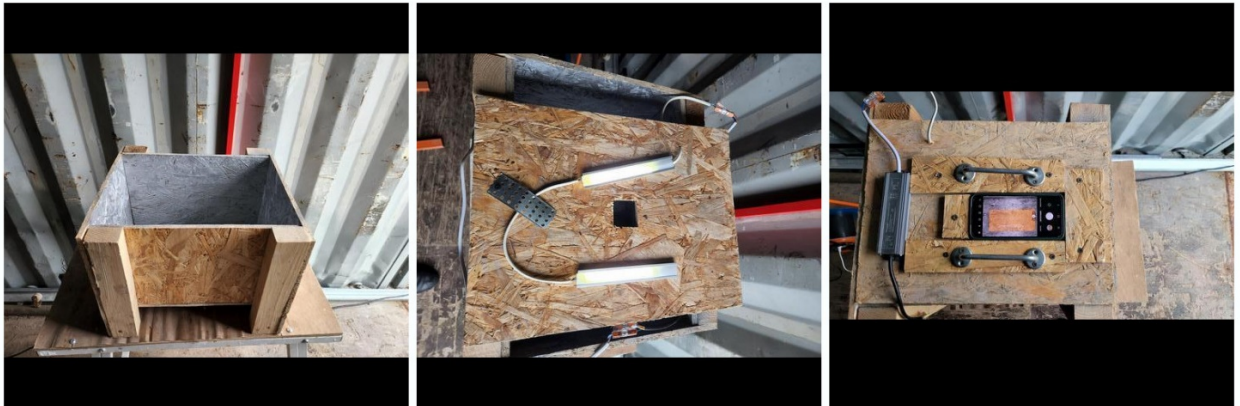
Рисунок 1. Стенд для фотосъёмки: а) вид без крышки, б) низ крышки с подсветкой, в) вид сверху
